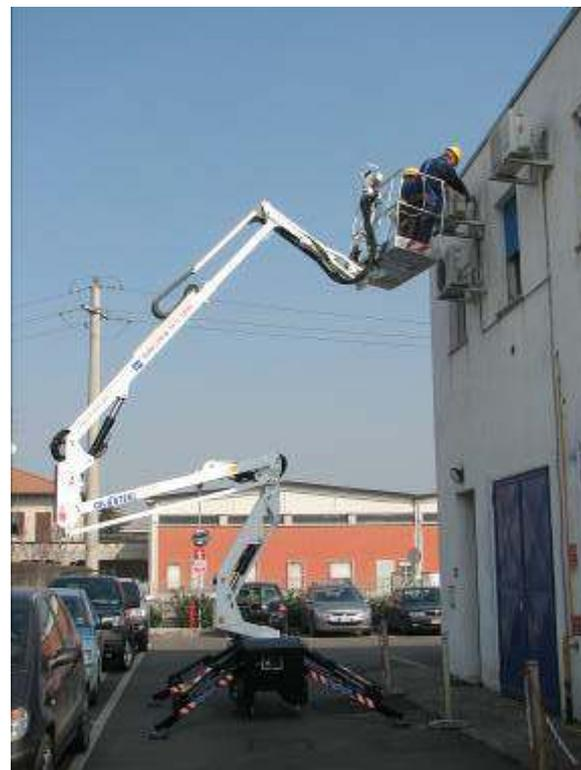
La torre articulada con un pantógrafo está accionada por un cilindro oleo dinámico que permite el trabajo en cuota del brazo teles cópico.
